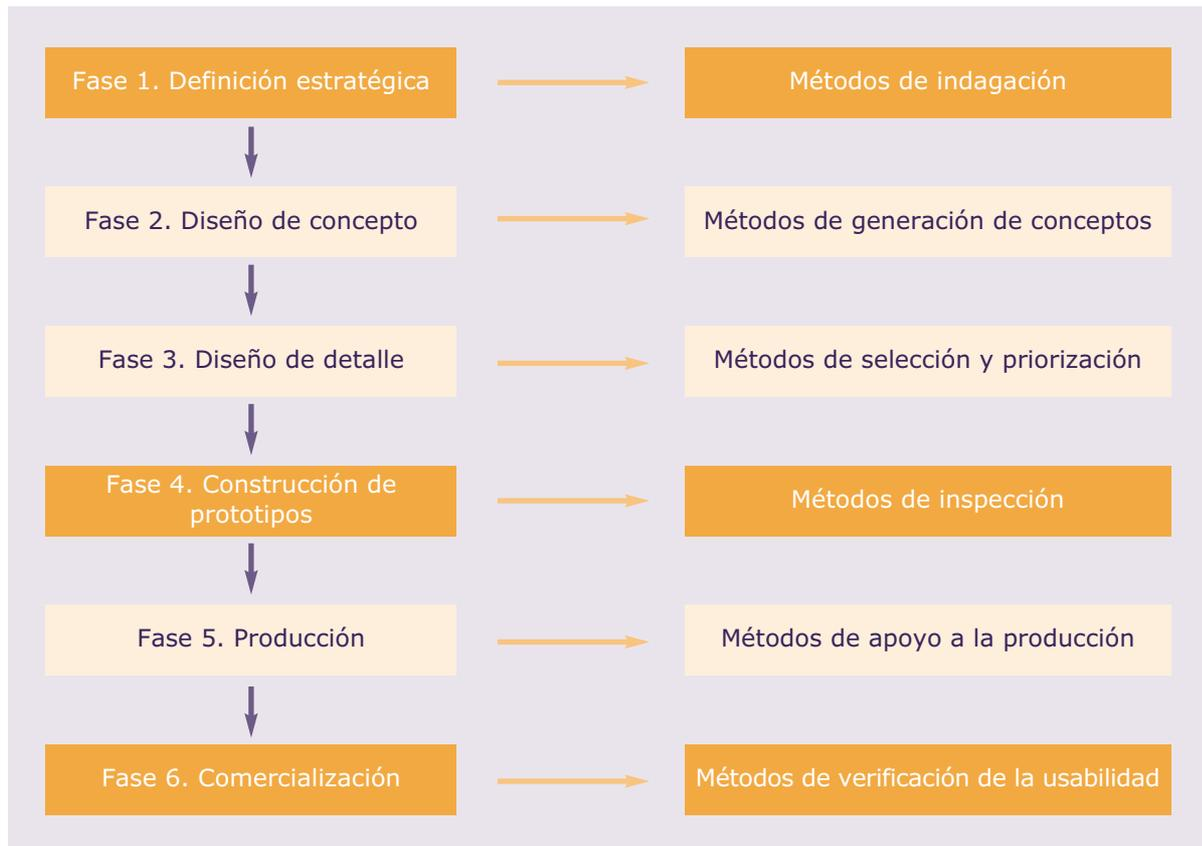
Los métodos, en función de la fase correspondiente del proceso de diseño, presentan unos objetivos concretos que se consiguen con la aplicación de unas técnicas específicas que se desarrollan en el siguiente apartado.
